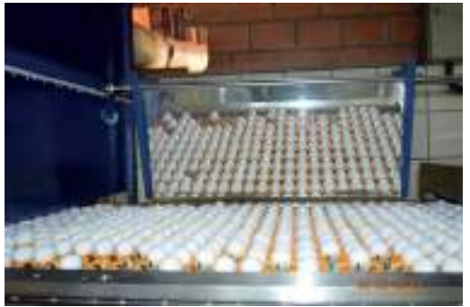
Deteção de ovos riscados por sensor
